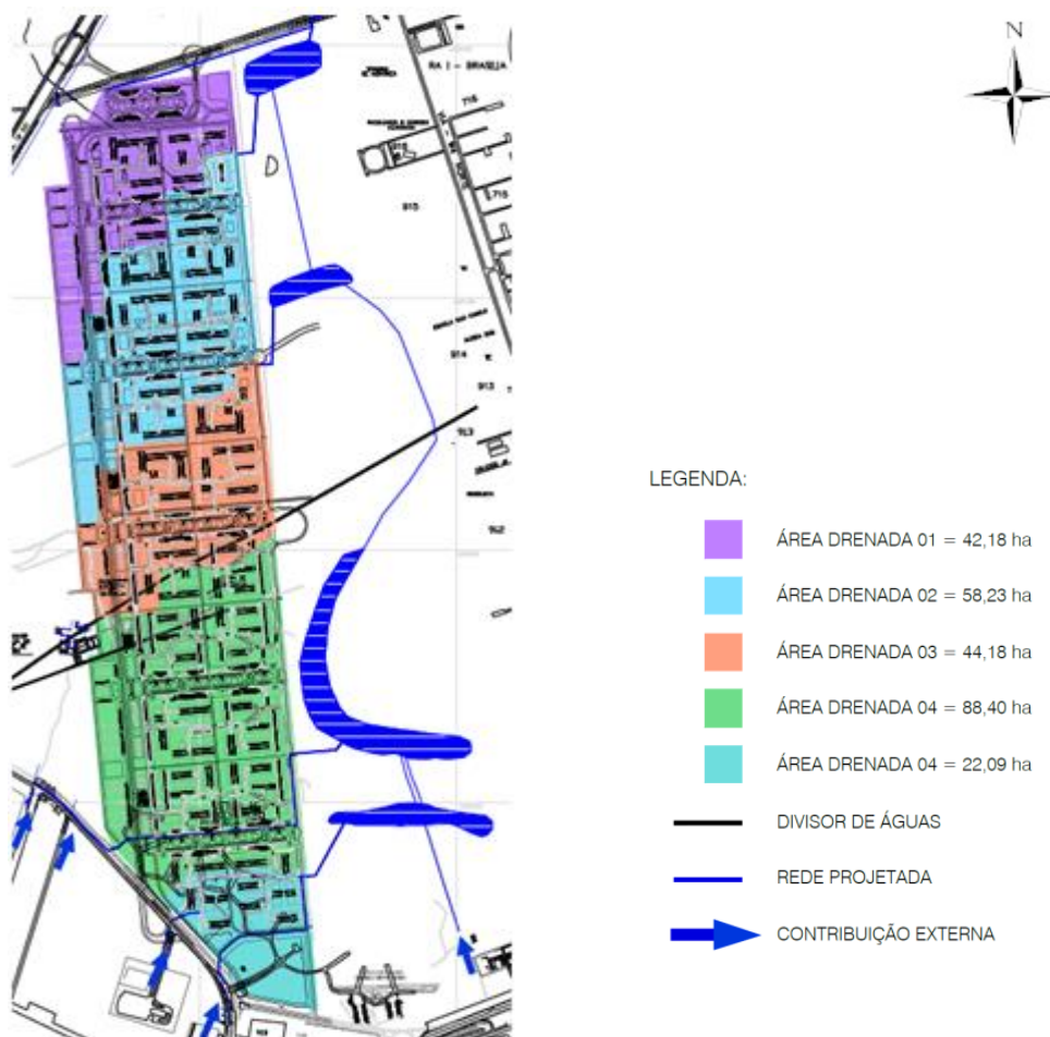
Fig. 3: Planta de drenagem pluvial (TOPOCART, 2007 – adaptado)
