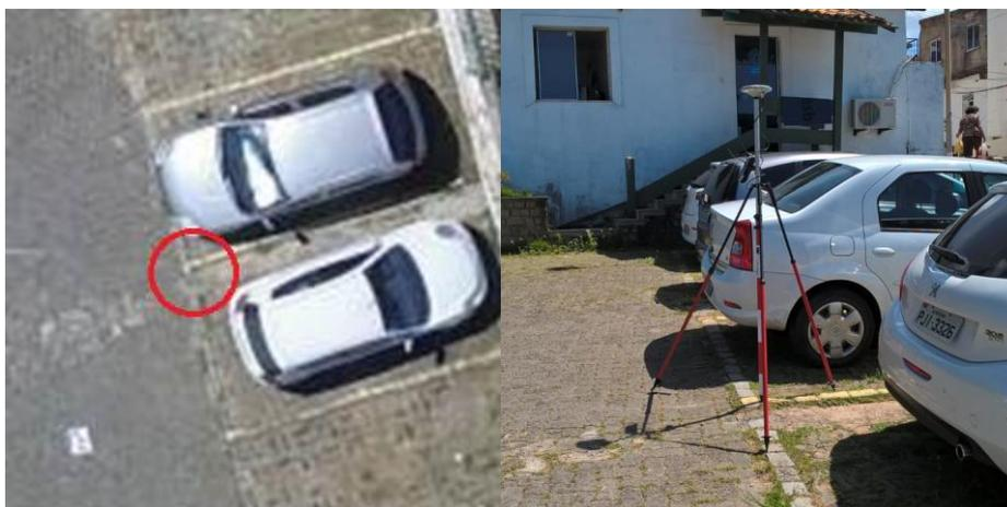
**Fig. 6 Identificação de um ponto de controle (vista superior e vista frontal)**
