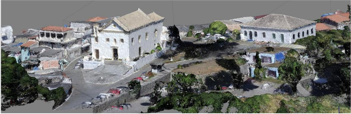
**Fig. 7** Nuvem densa de pontos editada com a retirada de vegetação
