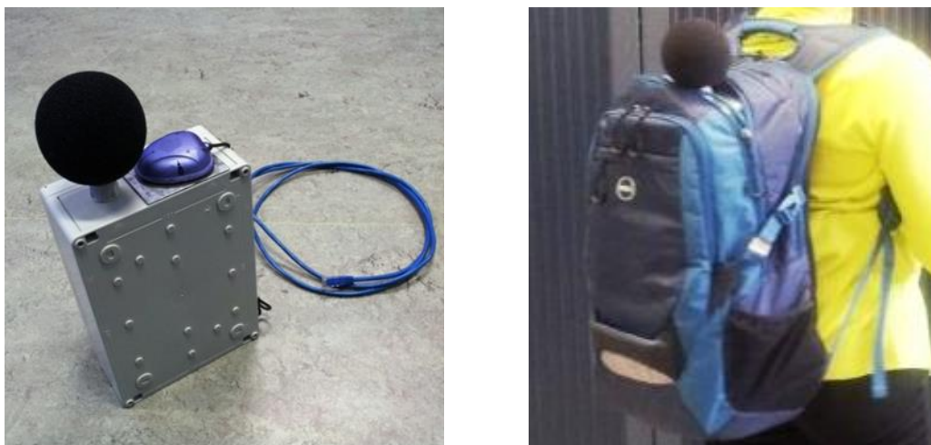
Fig. 2 Vista da unidade móvel desenvolvida pelo grupo INTEC-Acoustics e acomodação em mochila para o deslocamento a pé
